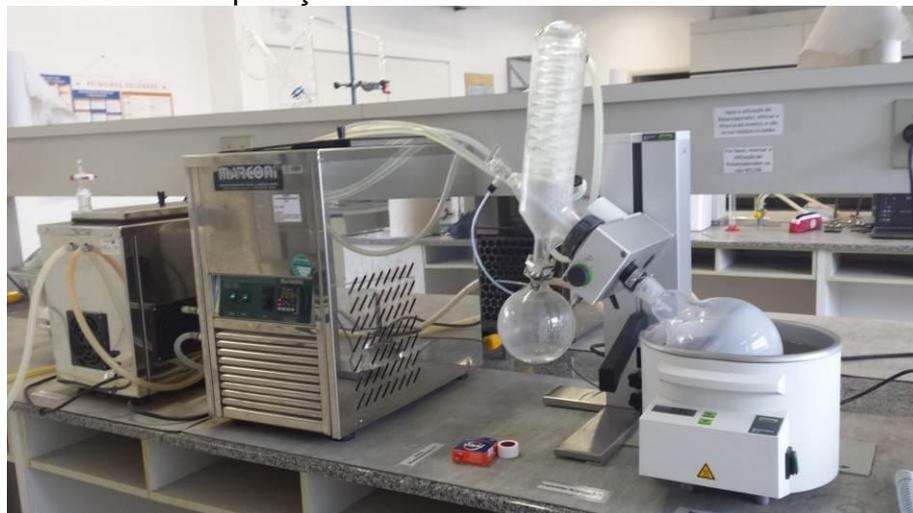
As condições de vácuo e temperatura ideais para este processo foram obtidos através de testes preliminares, onde observou-se o vácuo obtido no sistema e ajustou-se a temperatura ideal de evaporação para esta condição evitando projeção de amostra. Todas as amostras foram produzidas sob as mesmas condições de - 740 mmHg de pressão e temperatura de 50 °C até obter-se um brix de 70 °B aproximadamente no produto concentrado. Em função da impossibilidade de coletar-
