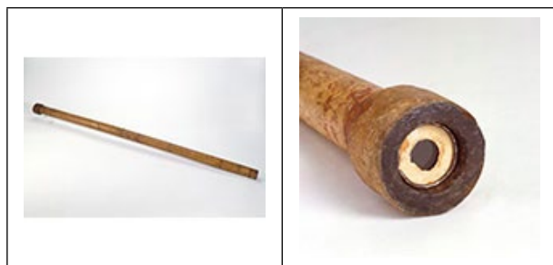
Figura 2 – Telescópio 5 original de Galileu com ampliação de 14 vezes.
