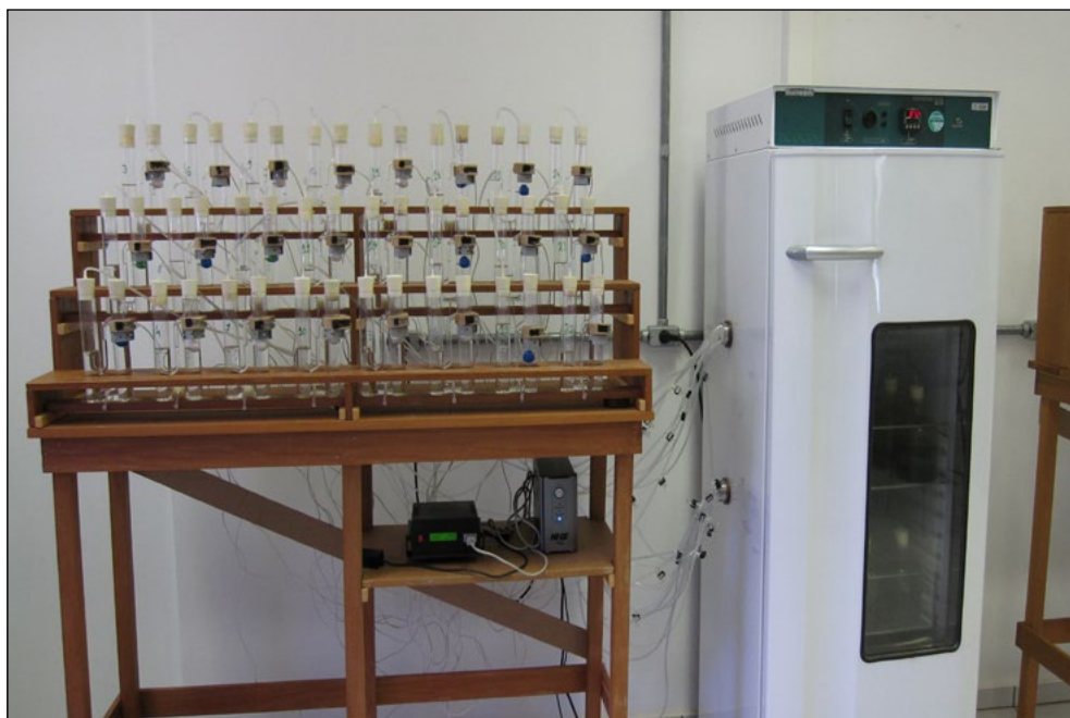
Figura 1 – Amostras incubadas conectadas ao sistema de medição de biogás
