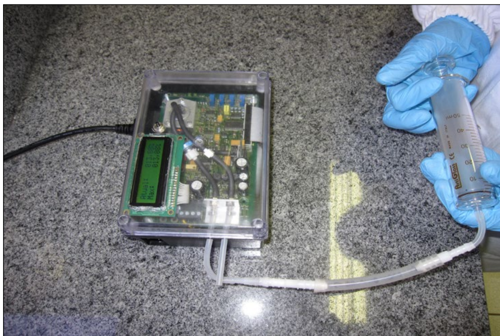
Figura 2 – Sensor específico para a medição de metano
