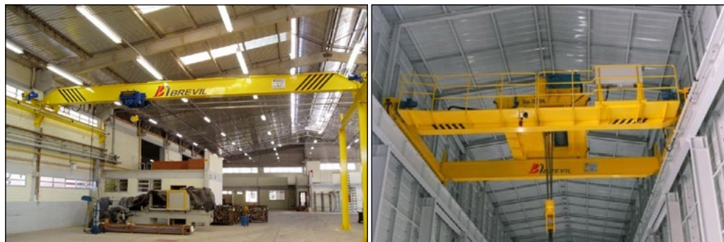
Figura 2 - Pontes rolante univiga e biviga
