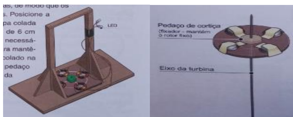
Figura 15 – Montagem da turbina.
