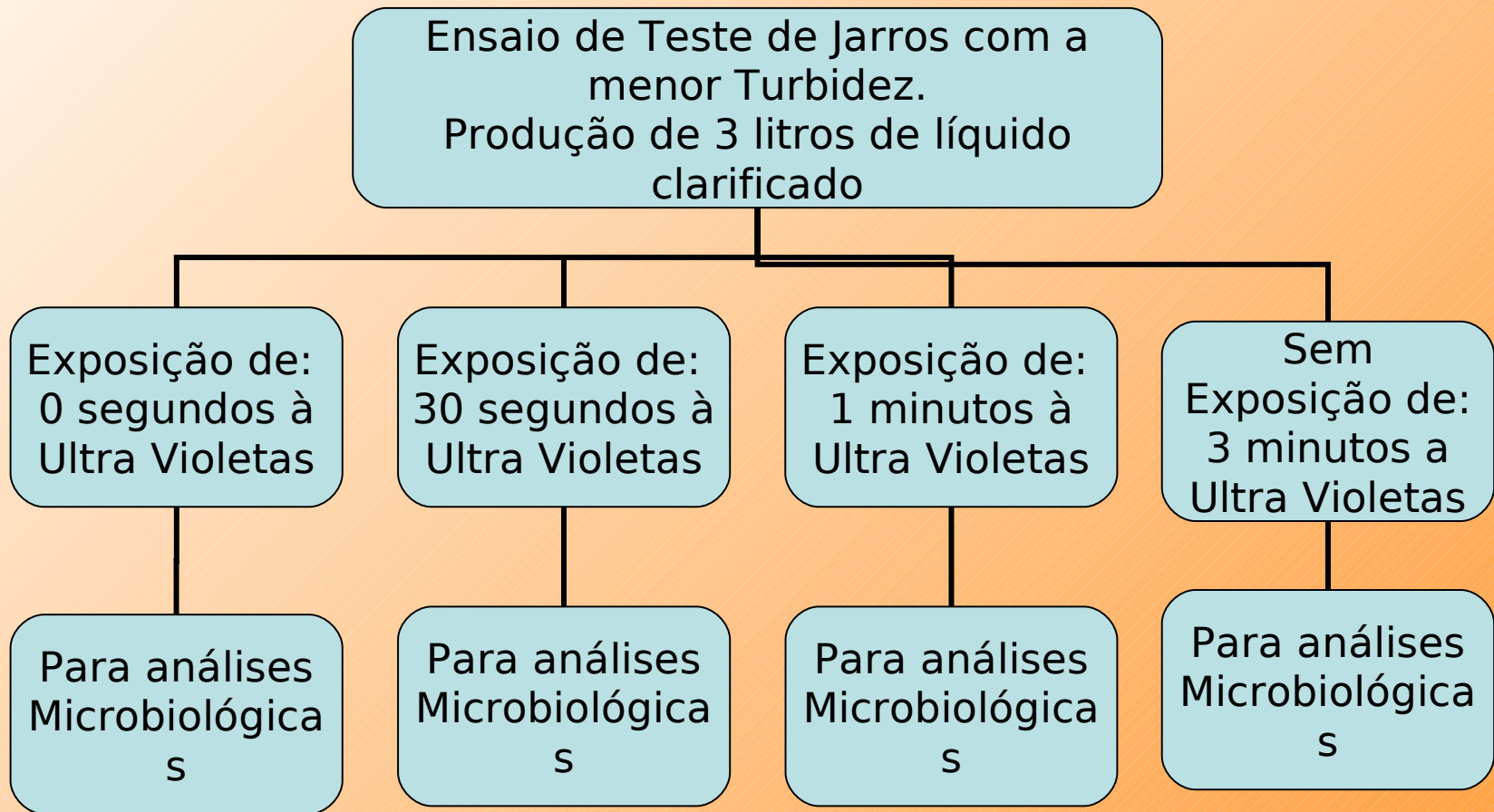
Figura 13: Apresenta o fluxograma de trabalho para Teste de Jarros final com emprego das lâmpadas Ultravioletas (efeito germicida)
