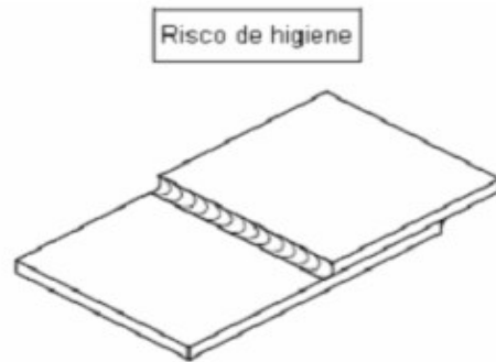
Junta sobreposta soldada de forma contínua
