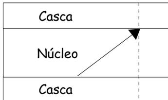
Sua propriedade de propagação dos feixes de luz está baseada no fenômeno da reflexão interna total da luz que ocorre na interface núcleo-casca. Designando por  $n_{\text{núcleo}}$  e  $n_{\text{casca}}$  os índices de refração do núcleo e da casca, respectivamente, analise as afirmações abaixo:
