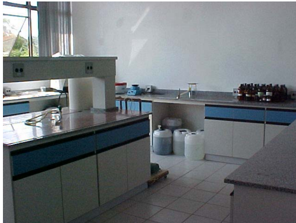
Figura 7 - Laboratório de Resíduos. Os resíduos químicos (líquidos ou sólidos) produzidos na Instituição são rotulados através do preenchimento de informações em programa específico (intranet) e recolhidos pela equipe do Laboratório de Resíduos que, após análise dos materiais, executa reciclagem ou encaminha para tratamento ou aterro industrial externo.
