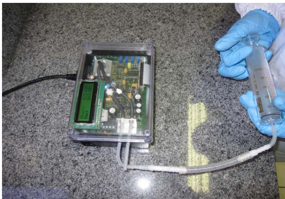
Figura 2. Sensor específico para a medição de metano
