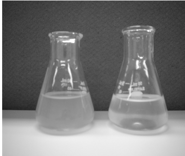
FIGURA 7 – Fotografia do efluente bruto após o tratamento no biorreator (à esquerda) e após o processo fotoeletroquímico a 3V (à direita).
